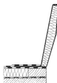
JET-Stahl-Alu-Verbund-AK Typ AK 40 cm hoch, Anschlussbeispiel: bituminöse Dachbahnen, 1. Lage
