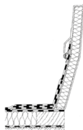
JET-GFK-RAK für RWA mit optionaler GFK-Schürze (Überhangstreifen)
